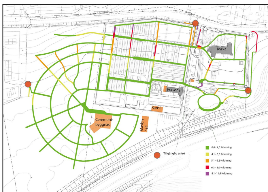
Illustrationsdiagram över tillgängliga passager inom kyrkogårdsområdet (befintliga och utvidgade delar). Mörk- och ljusgröna passager motsvarar lutningar mellan 0-5 %.
